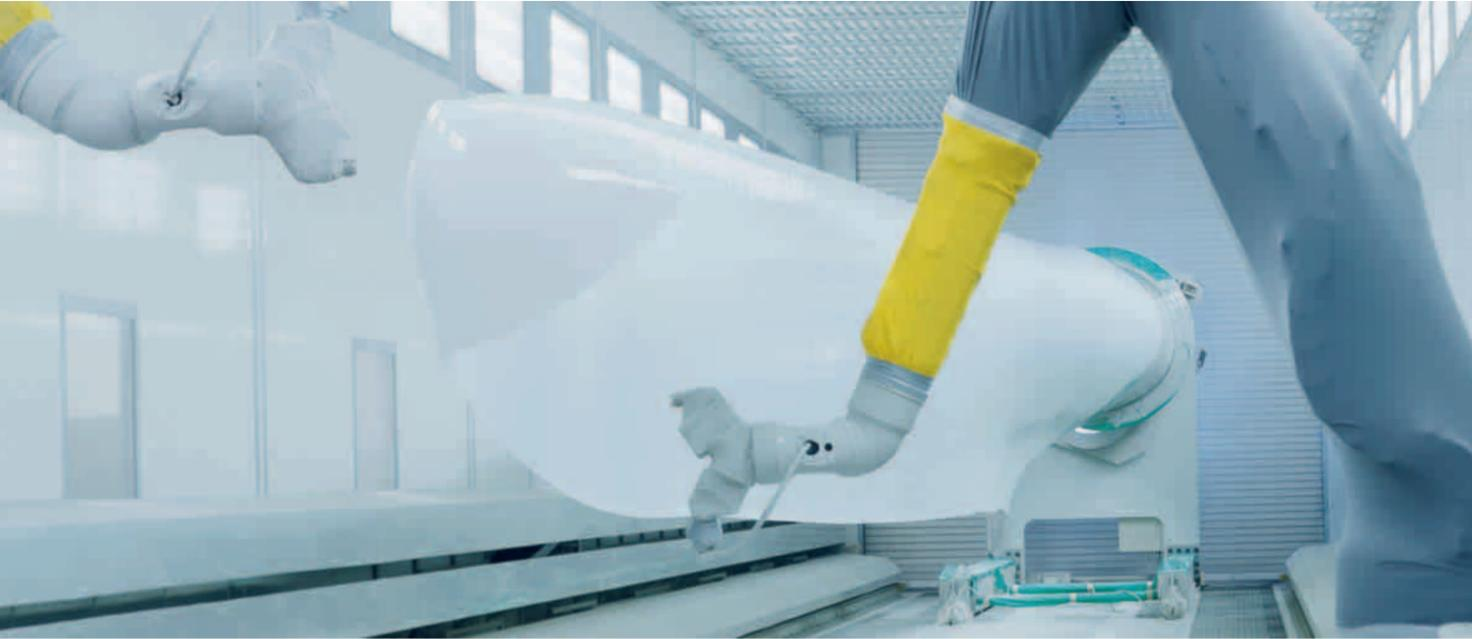
Un robot de peinture peint en une seule opération des pièces d'une longueur pouvant atteindre 35 mètres et assure ainsi une protection efficace des surfaces des pales contre les intempéries et les rayons UV ainsi que contre les problèmes d'érosion et de flexion
