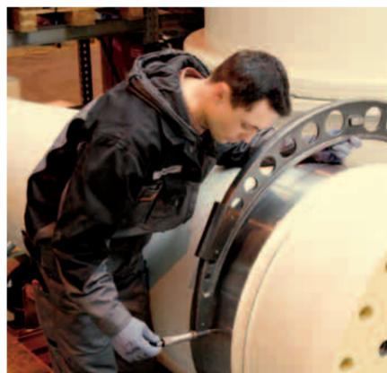
Vérification de l'ouverture de l'arbre de moyeu
