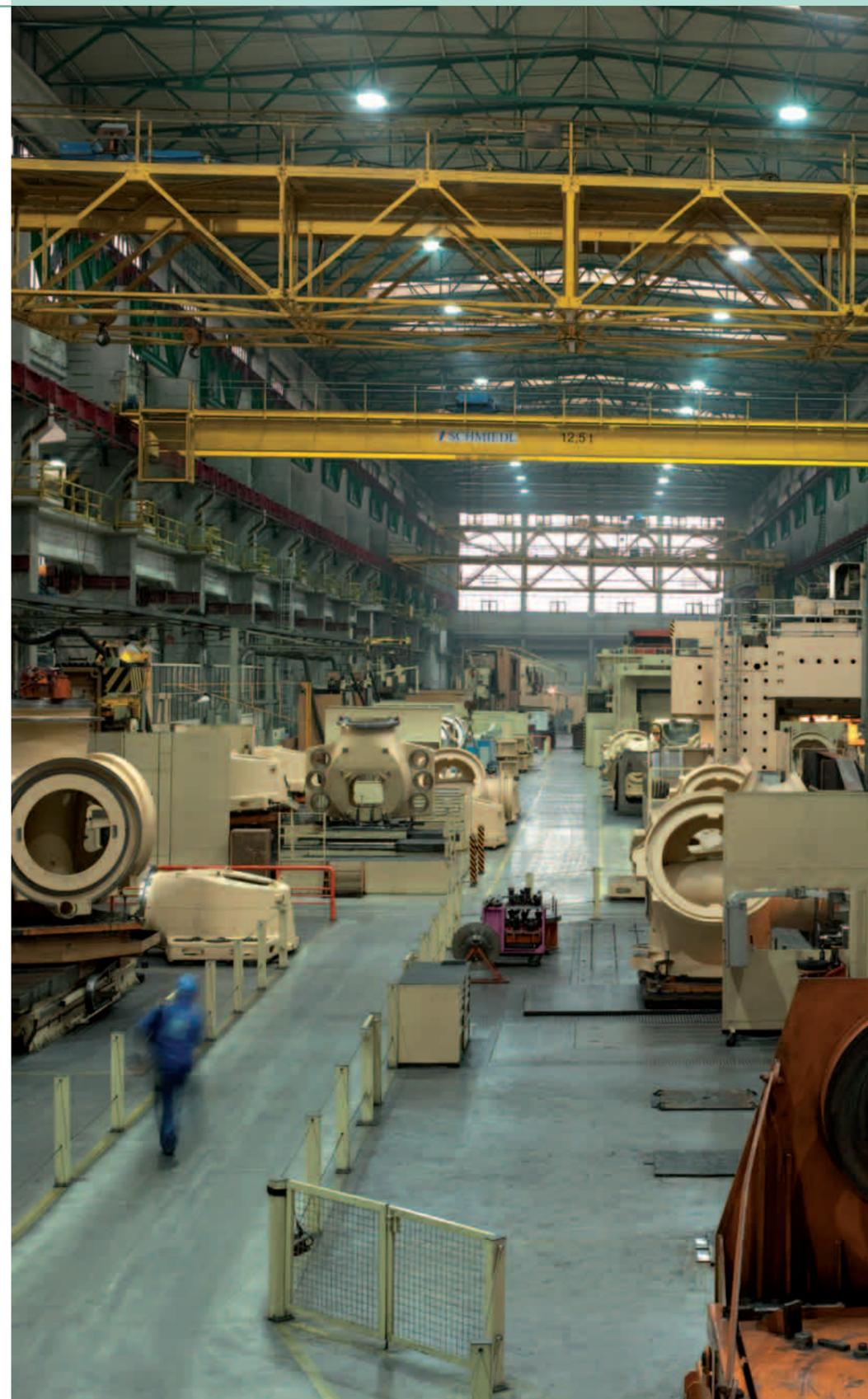
Tous les composants principaux tels que moyeu du rotor, adaptateur des pales, axe du moyeu et support machines sont fabriqués en fonte à graphite sphéroïdal et ensuite soumis à un traitement de finition.
