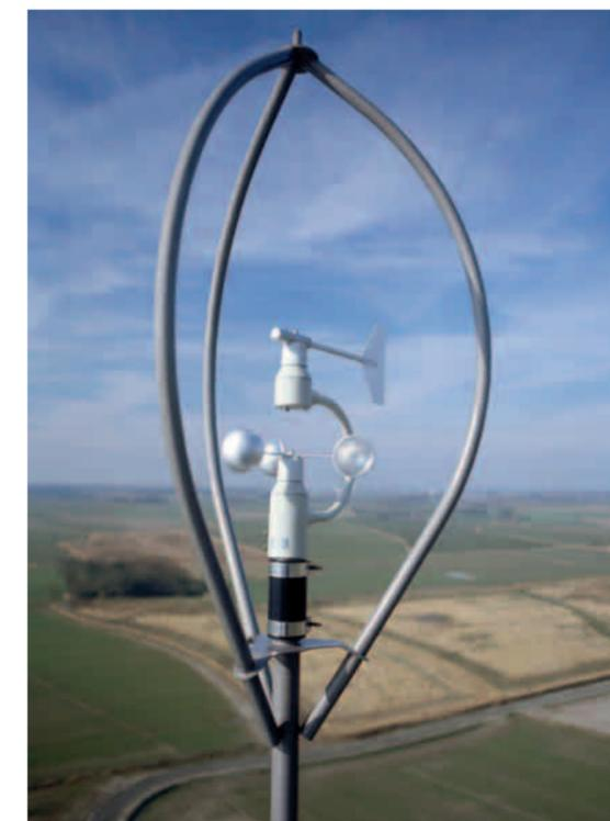
Appareil de mesure du vent sur une éolienne ENERCON
