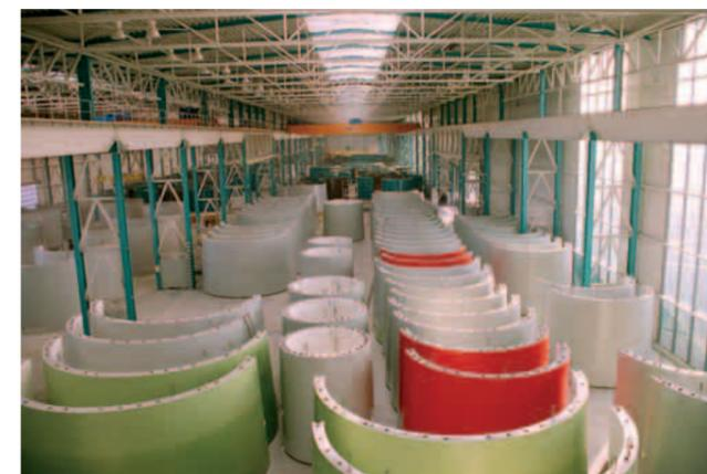
*Production de mâts ENERCON en béton préfabriqué*
