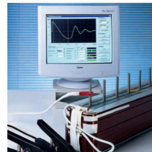
Assurance qualité ENERCON – test de tension de choc sur électroaimants et bobines d'induction
