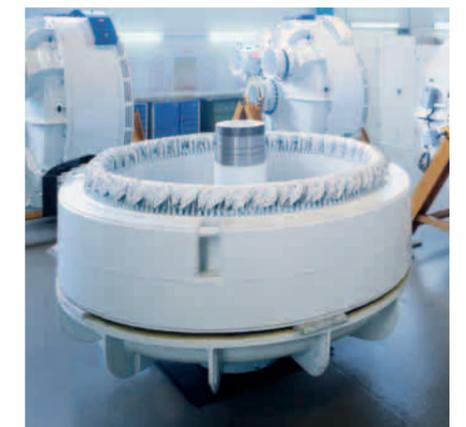
Stator (partie fixe) d'un générateur annulaire d'une E-33
