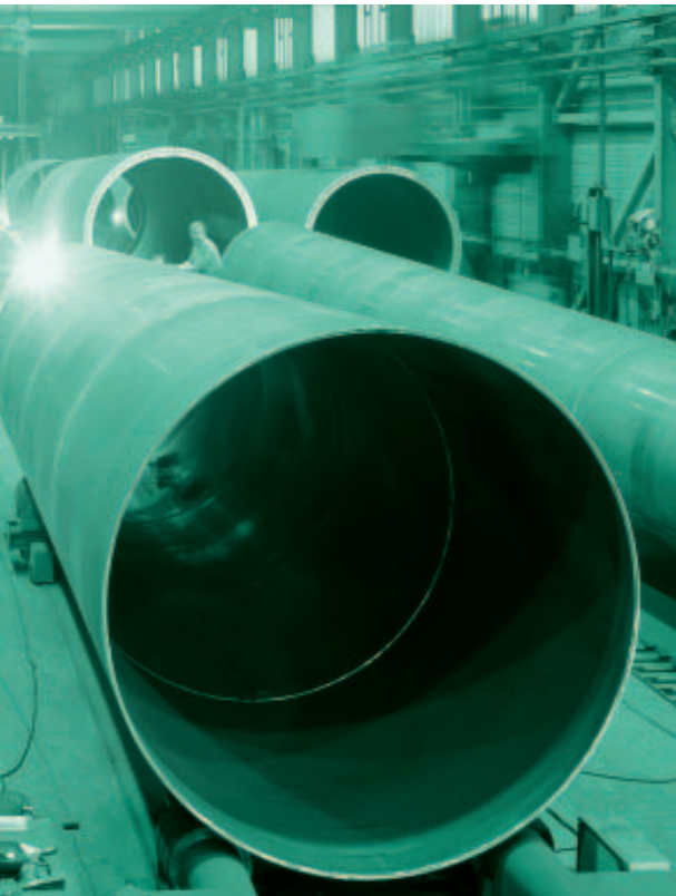
Fabrication de tours ENERCON en acier
