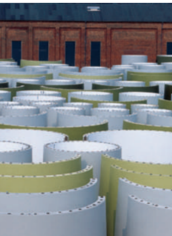
Segments de tour préfabriquée ENERCON en béton
